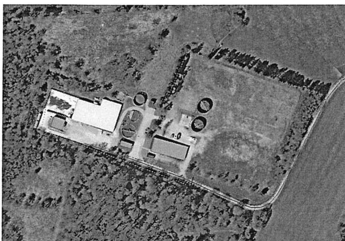
Reningsverket i Ormanäs byggdes 1978 med fyrstegsrening – mekanisk, biologisk, kemisk och filtrering. Efter det har reningsverket byggts ut i två omgångar med ytterligare behandlingssteg inom den mekaniska och den biologiska delen. Anoxbassängen byggdes 1995 som en del av införandet av kväverening.
